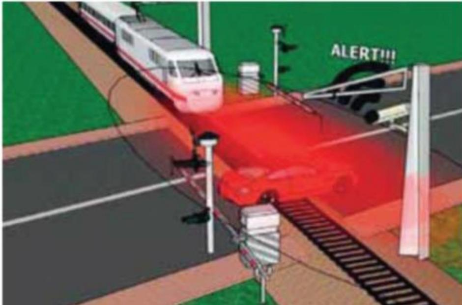
L'area interna alle barriere viene scansionata da sistemi radar, lidar o di altro tipo e l'autorizzazione al movimento del treno viene concessa solo se non viene rilevato alcun veicolo all'interno dell'area.
